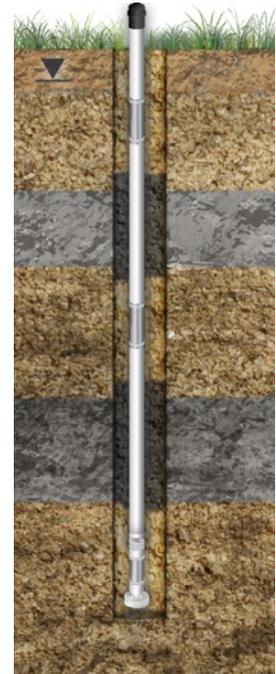
Typische Installation eines 3- oder 7-Kanal-Systems durch Verfüllung mit Sand- und Bentonitschichten
