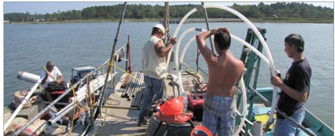
CMT-Systeme wurden am Grund einer Bucht installiert, um den Grundwasserabfluss zu messen. Acht 7-Kanal-CMT-Systeme wurden für den Einsatz im offenen Wasser konzipiert. Wasserdichte Brunnenköpfe mussten speziell angefertigt werden, um die Probenahme an der Oberfläche der Bucht mit einer Peristaltikpumpe zu ermöglichen.
