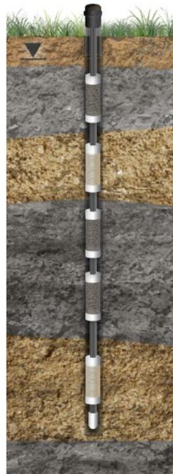
Typische Installation eines 3-Kanal-Systems mit Bentonit- und Sandpackern in Overburden
