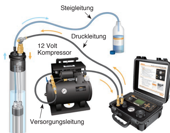
Pumpen-Aufbau mit einer elektronischen Pumpensteuerung Modell 464 mit 125psi/861KPa und 12-Volt-Kompressor
