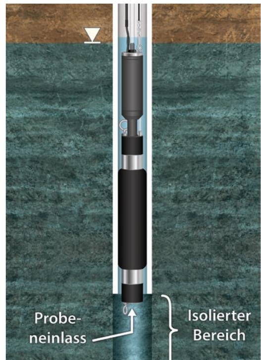
*Mithilfe des Packers Modell 800M kann die Probenahmezone isoliert und das Spülvolumen reduziert werden.*
